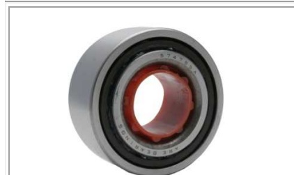
574795 BALERO DOBLE DEL NISSAN TSURU III= 514002= 107B1100
